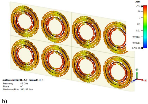
Şekil 2: Önerilen Tasarıma ait yüzey akım dağılımlarına a) alt kesim frekansı için b) üst kesim frekansı için
